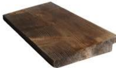
Detail po dokončení procesu šednutí (více jak 5 let na přímé povětrnosti).
