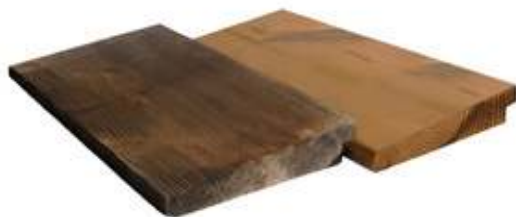
Detail nové a stářím zašedlé fasádní palubky (po kompletně dokončeném procesu šednutí).
